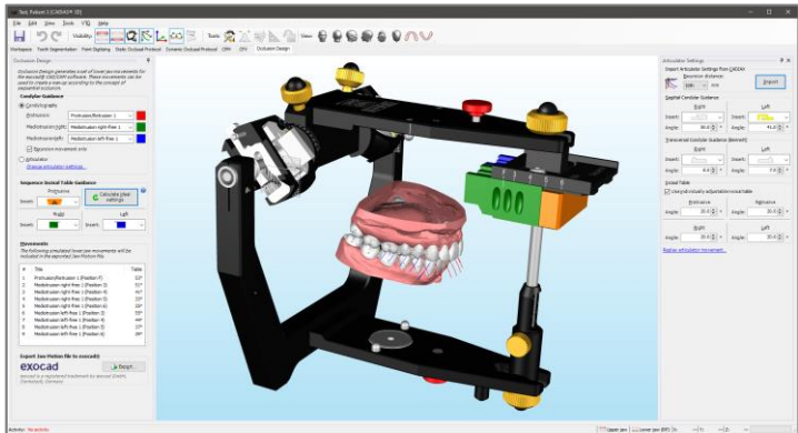
Abbildung 8: Die Benutzeroberfläche der Ansicht Okklusales Design erweitert den virtuellen Artikulator um einen voll einstellbaren Sequenz-Inzisaltisch.
