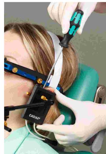
Fissare gli stili, con le rispettive viti, nelle prese dell'arco facciale inferiore. Il cavo dello stilo, una volta fissato, deve essere rivolto verso il basso.
