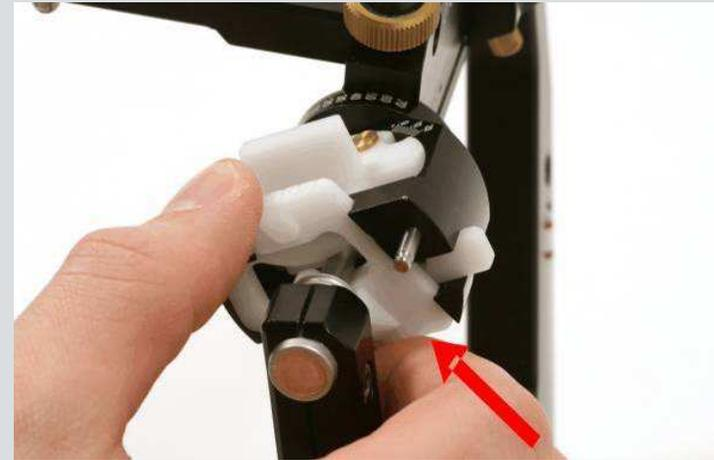
Schritt 2: Der Artikulator wird für die Montage vorbereitet: Inzisaltisch und Inzisalstift werden entfernt, Bissgabelstütze (06-230585) montiert und der Ü-Stand AB 2 (06-231400) **auf Anschlag** eingeschoben. Die beiden Stützbalken der Bissgabelstütze werden ganz nach unten geschoben und fixiert. Der Artikulator-Oberteil ist aufgeklappt und ruht auf dem Indexstift.
