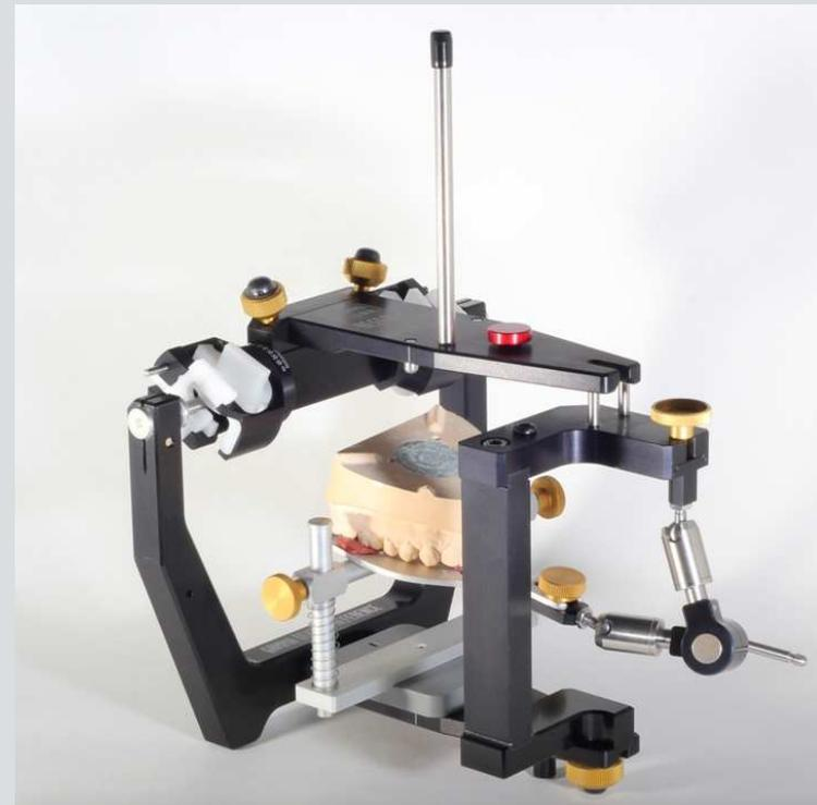
Schritt 5: Nun wird die Distanz zwischen Oberteil und Modell analysiert und der räumlich am besten füllende Sockel ausgewählt. Dabei sollte darauf geachtet werden, dass sich mit dem gewählten Sockel eine möglichst dünne aber gleichmäßig dicke Gipsschicht ergibt. Damit wird der Effekt der verzerrenden Gipsexpansion minimiert.
