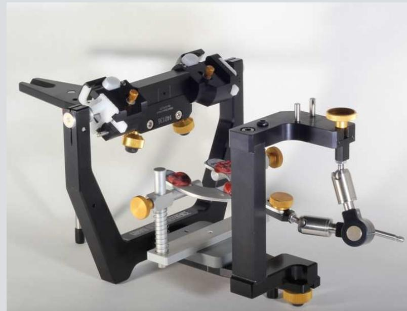
Schritt 4: Das Oberkiefermodell wird in die entsprechenden Impressionen der Bissgabel eingesetzt. Dann wird der Artikulator-Oberteil geschlossen, sodass er auf den vorderen Stiften des Transferstands aufliegt.
