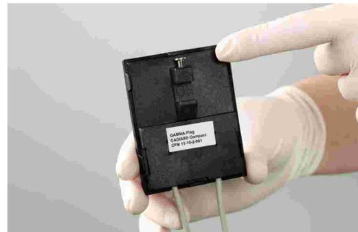
Fixieren Sie die Flaggen an den Flaggenadaptern des Erweiterungssets. Es darf nichts zwischen den Seitenarmen und Flaggen eingeklemmt werden.
