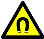
Die CADIAX Magnet-Sensorik ("M"-Sensorik) besitzt einen Magneten in der Spitze des Stylus. Aus diesem Grund ist mit dieser Sensorik besondere Sorgfalt bei der Anwendung bei Patienten mit Herzschrittmachern oder implantierten Defibrillatoren notwendig. Achten Sie unbedingt auf die Einhaltung der notwendigen Sicherheitsabstände! Konsultieren Sie u.U. den behandelnden Kardiologen. Im Zweifelsfall sehen Sie von der Anwendung der CADIAX "M" Sensorik ab.
