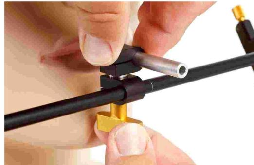
Stecken Sie die Achsnadeln in die Aufnahmen an den Enden der Seitenarme und stellen Sie diese so ein, dass die Achsnadeln ungefähr auf der Gelenkachse liegen.
