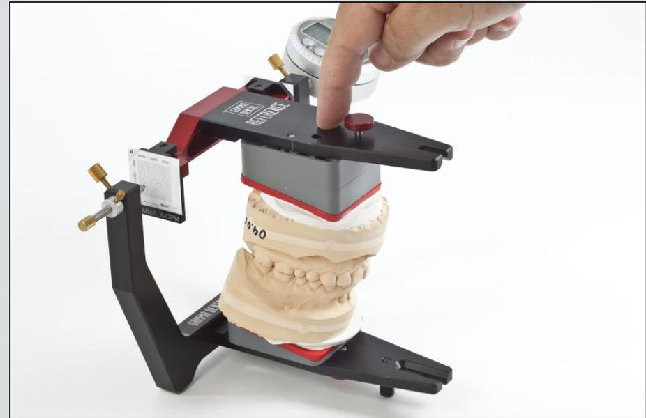
Schritt 15: Messspitze an die Flagge anschieben, Messwert ablesen und im Analyseblatt (Feld 'Transversal') notieren. Positive Messwerte zeigen eine transversale Verschiebung des Unterkiefers nach rechts. Negative Messwerte zeigen eine Verschiebung des Unterkiefers nach links.
