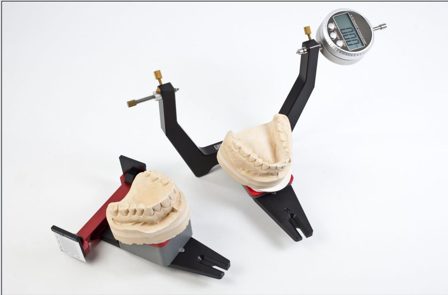
Schritt 9: Zentrikregistrat auf das UK-Modell aufsetzen und Position prüfen.
