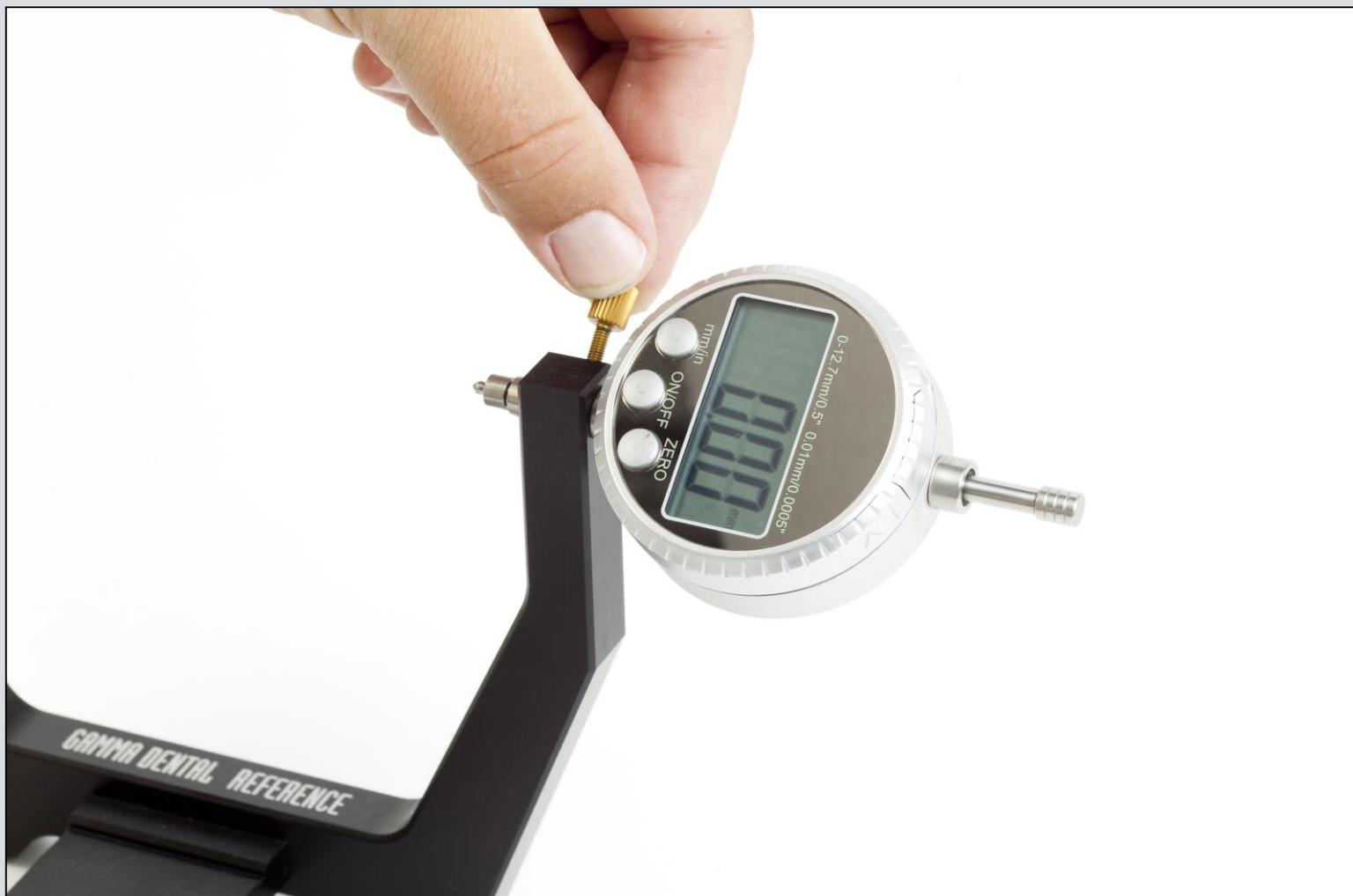
Schritt 2: Die Achse der Meßuhr wird ganz nach außen gedrückt.
