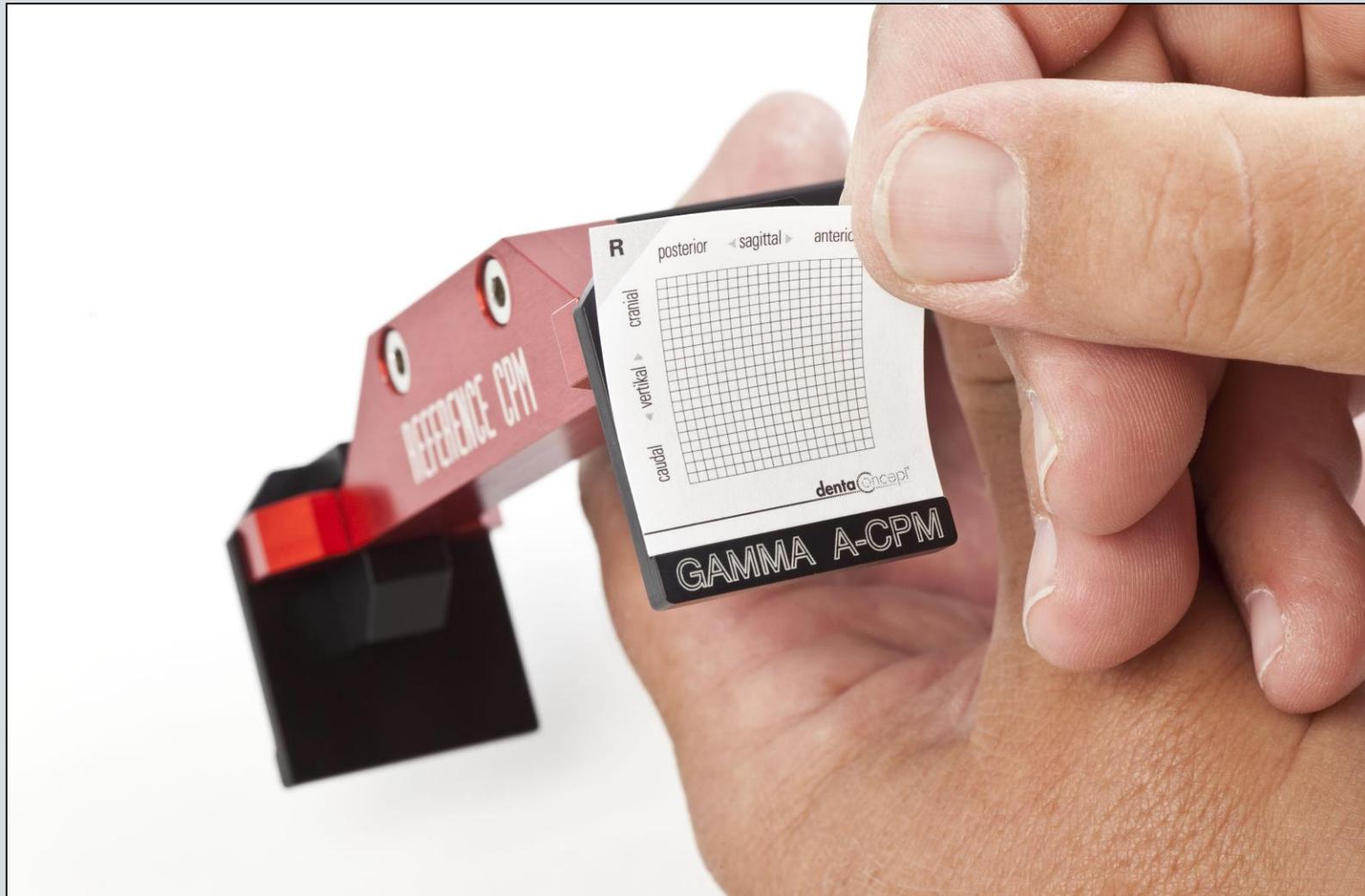
Schritt 6: Aufnehmungen (Ober- und Unterteil) des A-CPMs säubern.
