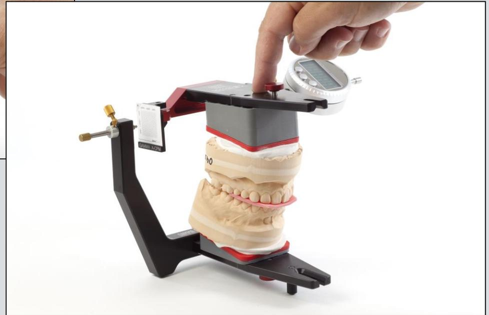
Schritt 11: Messuhr einschalten, Messspitze an die Flagge anschieben und mittels 'Zero' – Taste nullen. Prüfen, dass Messmodus 'mm' aktiviert ist.
