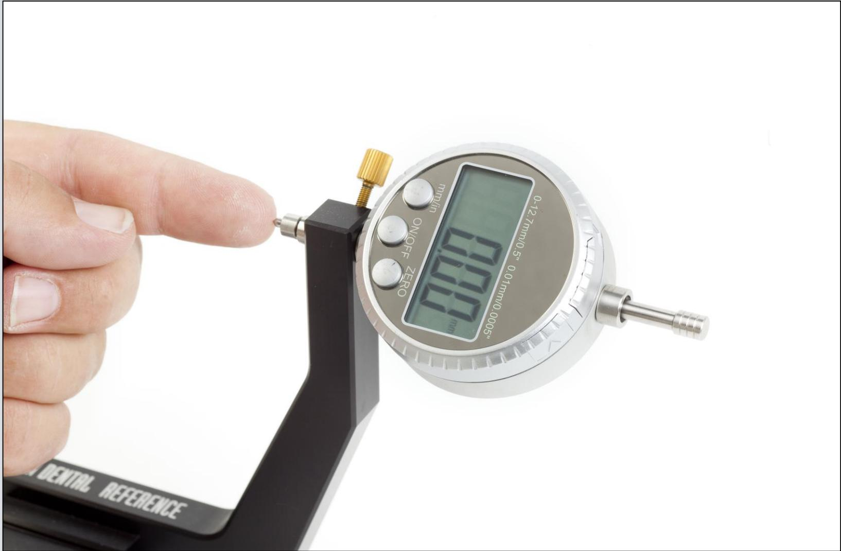
Schritt 3: Einsetzen und fixieren des Gegenstifts im A-CPM Unterteil auf der rechten Geräteseite. Die Klemmhülse des Stifts wird bis auf Anschlag eingeschoben und mittels Rändelschraube fixiert.
